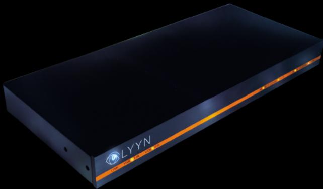
LYYN Hawk System は、19“ラックマウントタイプの画像改質装置です。アナログCCTV システムをリアルタイムで、Lynnify (改質)していきます。ビデオリソース切替スイッチを設置することで、全ての画像をLynnify することができます。LYYN Hawk System 1台あれば、同時並行的にチャンネルを視聴できます。オペレータは、どのカメラでも選択し・切替ことができ、必要な時にLynnify された画像を確認できます。
